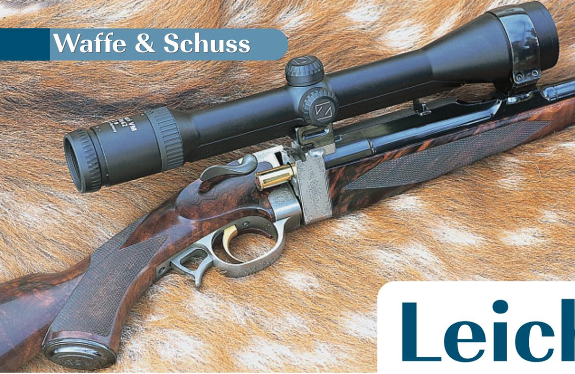
Die Drehbewegung zum Öffnen des Verschlusses ist körpergerecht und ergonomisch; der Lauf bleibt in Schussrichtung und muss nicht abgekippt werden (Vorteil beim Liegendschießen oder auf dem Hochsitz). Gewöhnungsbedürftig ist nur der visuelle Eindruck des vom Schaft seitlich „weggedrehten“ Laufs.
