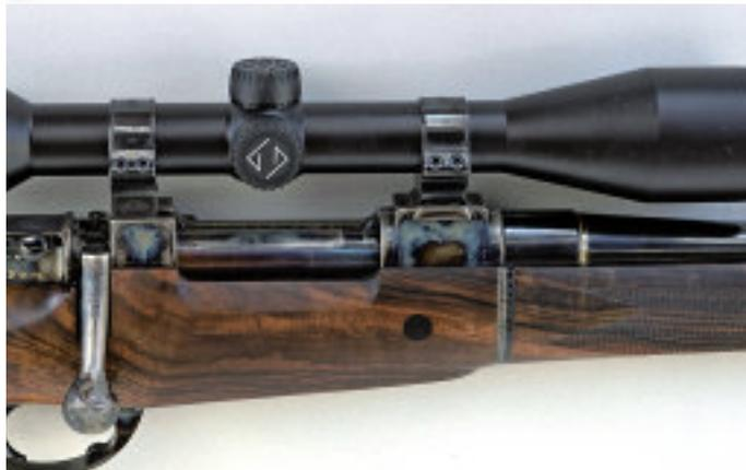
umlegen lässt. Zwei Druckknöpfe arretieren ihn in hinterer und mittlerer Stellung. Ein unbeabsichtigtes Entsichern beim Führen der Waffe ist unwahrscheinlich. Die Sicherung blockiert den Schlagstift und sperrt die Kammer. In Mittelstellung kann gefahrlos entladen werden. Einer niedrigen Zielfernrohrmontage steht sie nicht entgegen.
